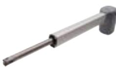
**KINEO 400** Motorréducteur électromécanique irréversible 230 Vac. Structure extrudée en aluminium. Fin de course en ouverture et/ou fermeture facilement réglable (OPTIONAL). Course 400mm.
