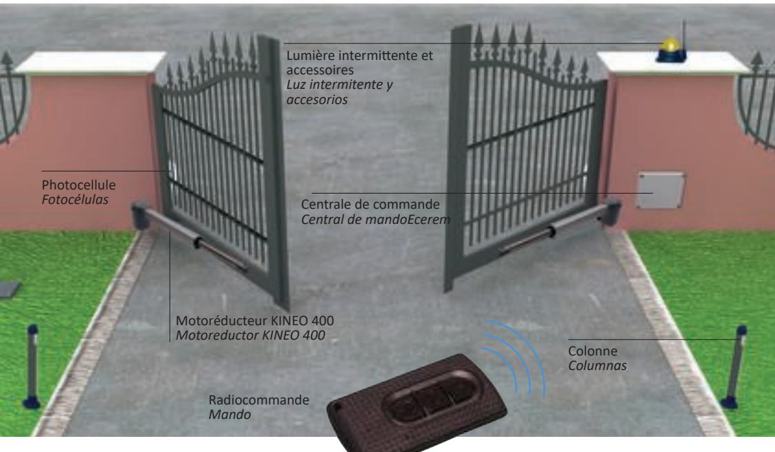
> Motoréducteur électromécanique KINEO 400 pour portails battants, idéal pour les portails à usage résidentiel.
